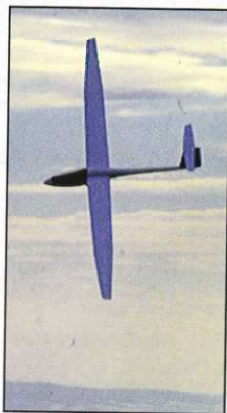
Les planeurs utilisent des voilures à grand allongement.
